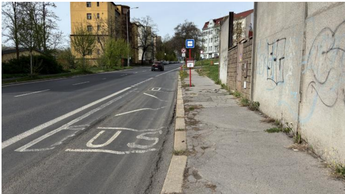
Obrázek 10: Neadekvátní výška nástupní hrany a chybějící OOSPO v zastávce Klíšská.
