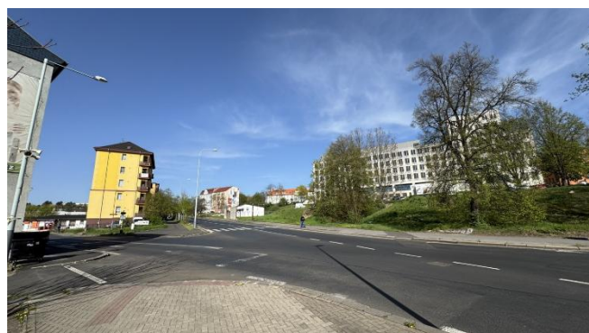
Obrázek 13: Špatné rozhledové poměry vlivem špatného úhlu křížení komunikací Klíšská × Londýnská × Solvayova.
